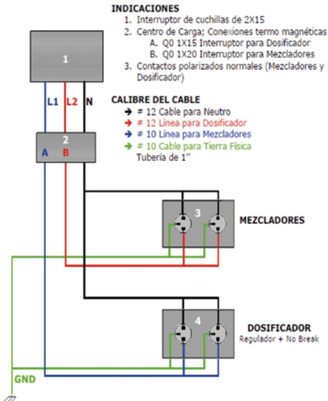
**IMPORTANTE:** El presente diagrama indica las características necesarias con las que debe contar su instalación eléctrica, las líneas deben ser exclusivas para el uso de los equipos tintométricos, cualquier desviación invalidará la garantía del equipo y/o refacción.
